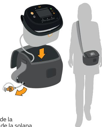
**Precaución:** Se recomienda no cargar la bomba mientras está en la bolsa de transporte, ya que esto puede hacer que la temperatura de funcionamiento sea elevada, lo que a su vez podría hacer que la bomba suspenda la carga hasta que se enfrié. La bomba seguirá funcionando. Para reducir la temperatura de funcionamiento de la bomba, sáquela de la bolsa de transporte y llévela a un entorno con una temperatura ambiente más baja. Cuando la bomba se enfrié, se reanudará la carga automáticamente.
